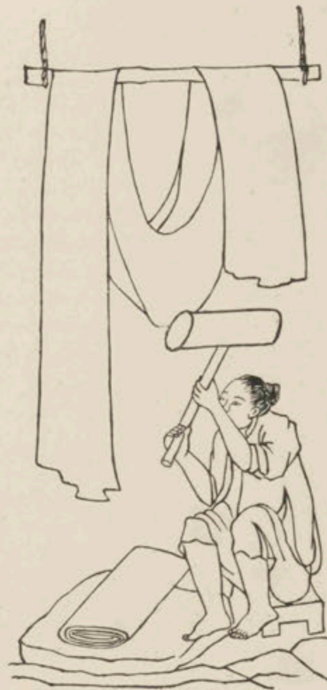
FIG. 20. — TEINTURIER BATTANT UNE PIÈCE DE COTON
